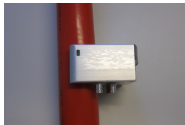
图 7: 确保传感器安置后, 电压 BNC 接口朝下。
