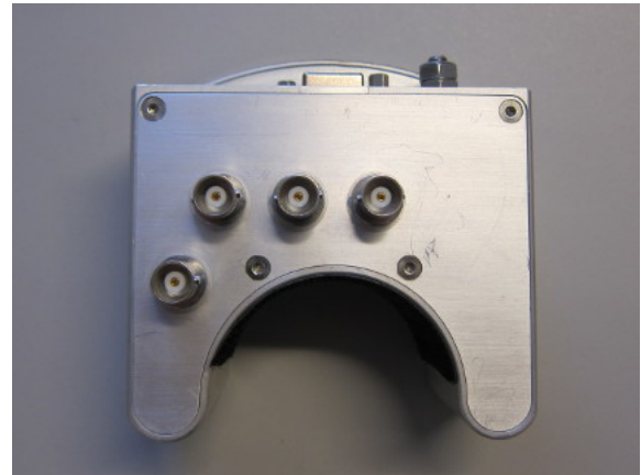
图 3: 电压测量 BNC 接口, 从左下角至右端分别为: Null, L3, L2, L1。
