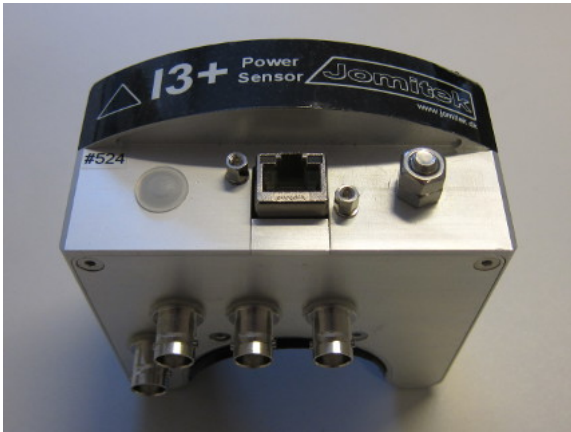
图 2: I3 传感器前部及底部展示图。其中包含 PoE 接口, 接口, 电压测量 BNC 接口。
