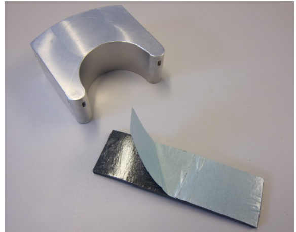
图 13: 使用粘性橡胶片沾粘在传感器上。
